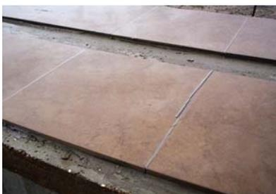
Ensaio de desempenho de revestimento em porcelanato avalia a contribuição da aderência, flexibilidade e espessura de juntas de colocação na ruptura à flexão. No detalhe, esmagamento da argamassa do rejunte à compressão
